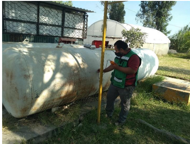
Ilustración 12. Diagnostico por ultrasonido a tanque de gas.
